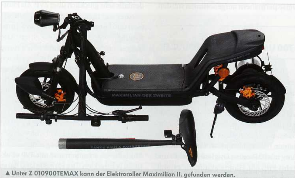
▲ Ist der Akku, der aus drei 12-V-Akkus besteht, einmal leer, reichen drei bis vier Stunden an der 230 Volt Steckdose und die Fahrt kann weitergehen.
