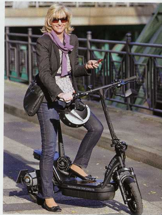
▲ Maximilian II. entpuppt sich im Alltag als überaus pflegeleicht. Der Direktantrieb ist wartungsarm, verschleißfrei und verschmutzungssicher.
