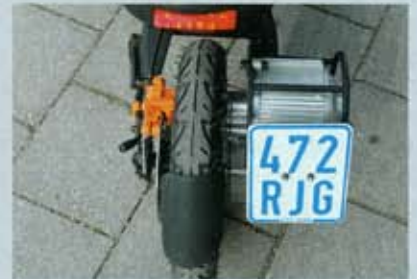
Der Motor treibt das Hinterrad direkt an. Über dem Rad mit Scheibenbremse sitzt das Brems- und Rücklicht
