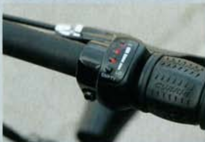
Neben dem Drehregler befindet sich die Ladekontrollanzeige. Bis zu 30 km fährt der Roller mit einer Akkuladung
