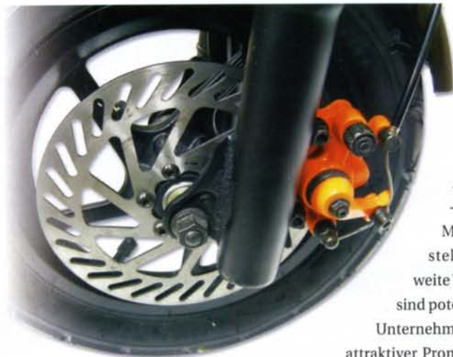
BREMSE: „Maximilian II“ ist mit modernen Dual-Disk-Scheibenbremsen ausgestattet.
